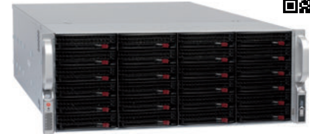
ES-3036 als Hardened Linux Immutable Repository mit 36 Slots (12 davon auf der Rückseite)
