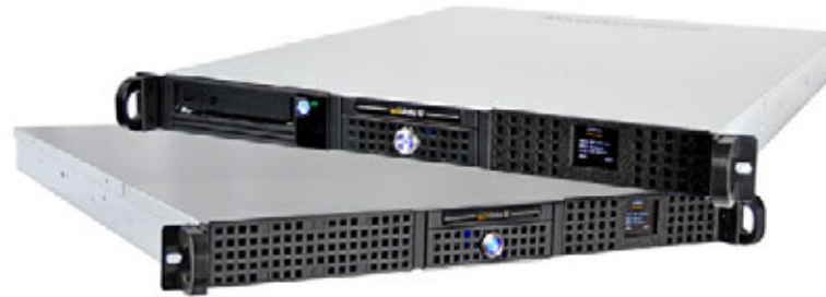
actidata T-Pontis 1U-Bi als 10GbE-to-SAS-Bridge & T-Pontis 1U-LTO mit eingebautem LTO-Laufwerk.
